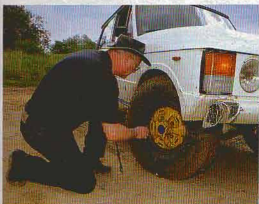
Klassischer Trick: Luftdruck senken für mehr Traktion
